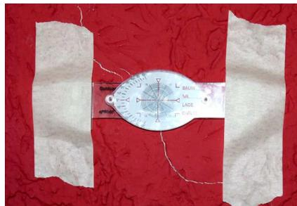
Nun können Sie den Rissmonitor an der gewünschten Stelle ankleben. Drücken Sie die Klebebandstreifen fest auf die trockene und staubfreie Oberfläche. Durch die Klebebandstreifen wird verhindert, dass der Rissmonitor, bis der Kleber abgebunden hat, abrutscht. Ebenso wird ein Abtropfen des flüssigen Klebers verringert.
