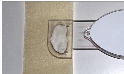
Drehen Sie den Rissmonitor um und bringen Sie den angemischten 2-Komponenten-Kleber im Bereich der Bohrungen auf die Rückseite des Rissmonitors auf.
