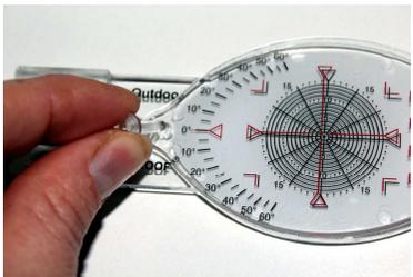
Verbinden Sie das Ober- und Unterteil des Rissmonitors durch Einsetzen der Montagehilfen. Hierzu drücken Sie die zwei kleinen Bolzen durch die kleinen Löcher der oberen und unteren Platte. Achten Sie darauf, dass die Montagebolzen nicht über die hintere Platte hinausragen. Durch vorsichtiges Zurückziehen und Drücken der Bolzen kann eine eventuelle Nachjustierung durchgeführt werden.
