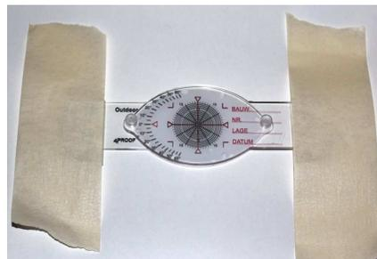
Bei Montage durch Ankleben mit Epoxydharz Kleben Sie nun rechts und links einen ca. 10 bis 15 cm langen Streifen Papierklebeband auf die Sichtseite auf. Achten Sie hierbei darauf, dass die vorhandenen Löcher in den Rissmonitorteilen abgedeckt werden.
